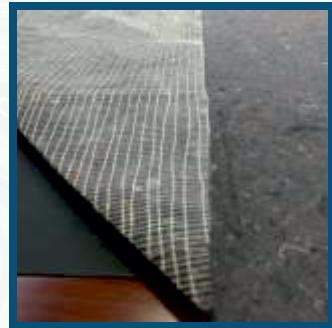
**Армированный Геотекстиль нетканый игло пробивной MARJA TEX** – это материал, изготовленный из полиэфирных и армирован с помощью прочного нетканого волокна. Выполняет разделительную, фильтрационную, дренажную и защитную функции. Полиэфирный материал отличается стойкостью к прямому излучению ультрафиолета, а, в свою очередь, полипропиленовый – к воздействию щелочей в почве. Допускается хранение в упакованном виде на открытых площадках.
