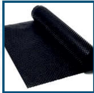
**Профилированная мембрана** – рулонный материал с отформованными округлыми выступами, изготовленный на основе полиэтилена высокой плотности (ПВП). Дополнительными слоями могут быть геотекстильное полотно и скользящий слой из полиэтиленовой пленки. Благодаря поверхности с множеством упорядоченных выступов (шипов), мембрана эффективно распределяет давление грунта по всей площади основания или фундамента зданий и сооружений, что исключает образование локальных (точечных) нагрузок.
